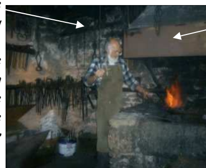
Tige reliée au soufflet, le forgeron tient une poignée pour l'actionner.
