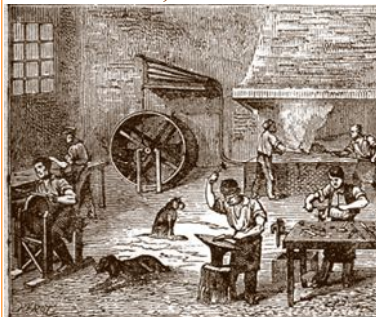
ATELIER DE COUTELLERIE À THIERS.- La coutellerie fabrique tous les couteaux, grands et petits, dont nous servons, ainsi que les canifs, grattoirs, etc. Les ouvriers représentés préparent les lames. D'autres, pendant ce temps, ont préparé les manches des couteaux, il n'y aura plus qu'à les emmancher. Le grand soufflet, qui sert à exciter le feu de la forge est mis en mouvement par un chien qui tourne dans une sorte de cage ronde comme font les écu-reuils
