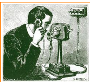
TÉLÉPHONE. – Le mot téléphone signifie : qui parle au loin . On transmet le long des fils électriques un courant qui réussit à reproduire les sons des voix.
