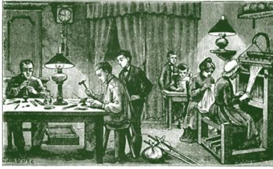
LE TRAVAIL DU SOIR DANS UNE FERME DU JURA.—C'est dans les fermes du Jura que se fabriquent en grande quantité les ressorts de montre les plus délicats. En passant près des fermes, il est rare qu'on n'y entende pas le bruit du marteau ou de la lime. - Le métier à bas, auquel travaille la fermière de droite, a été inventé par un Français, un ouvrier serrurier des environs de Caen. Avec ce métier on fabrique, bien plus vite qu'avec la main, des bas presque aussi solides.
