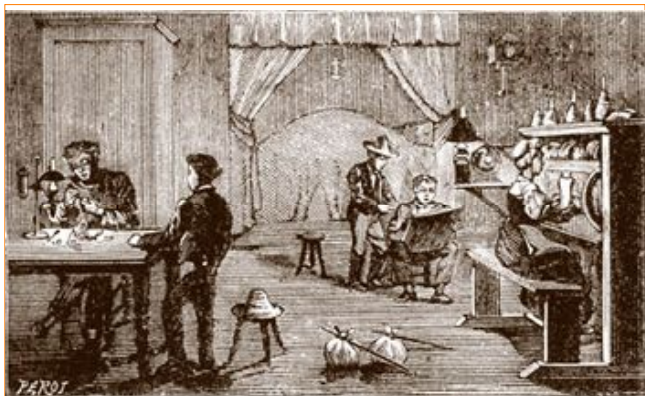
LE TRAVAIL DU SOIR DANS UNE FERME DU JURA.—C'est dans les fermes du Jura que se fabriquent en grande quantité les ressorts de montre les plus délicats. En passant près des fermes, il est rare qu'on n'y entende pas le bruit du marteau ou de la lime. - Le métier à bas, auquel travaille la fermière de droite, a été inventé par un Français, un ouvrier serrurier des environs de Caen. Avec ce métier ou fabrique, bien plus vite qu'avec la main, des bas presque aussi solides.
