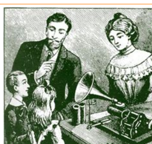
PHONOGRAPHE. – Le phonographe garde l'empreinte des sons, et peut les reproduire comme la photographie reproduit la forme des objets.
